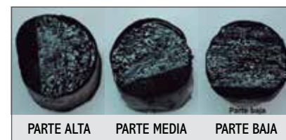
Figura 4: Método de análisis de la dispersión de NFU en la emulsión
