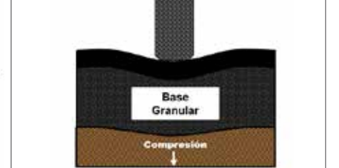
Figura 4.b Falla por Deformación
