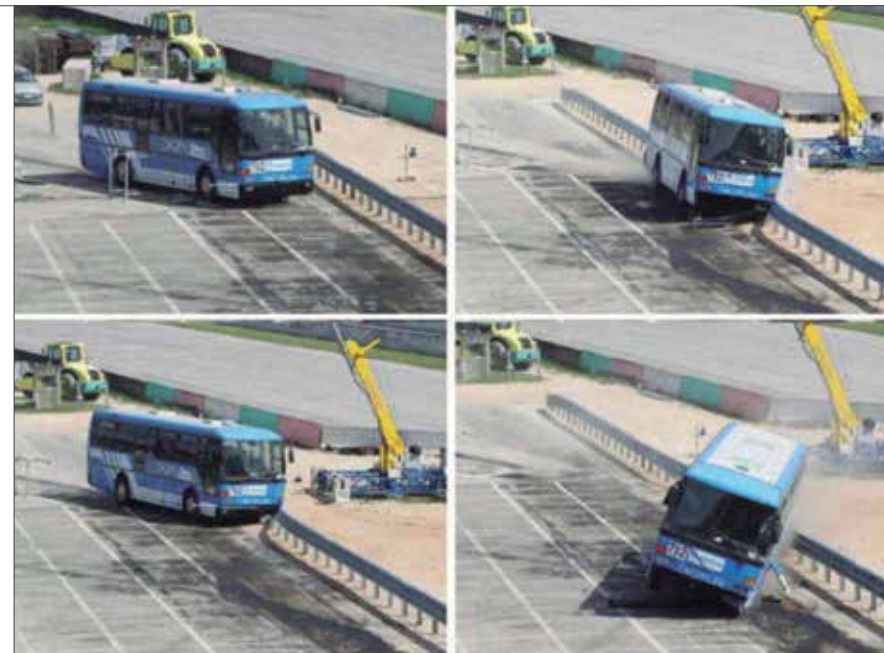
Secuencia del impacto de un bus contra las barreras de seguridad que se han colocado en la avenida Javier Prado.
