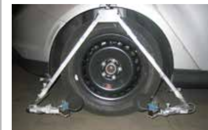
FIGURA 20: INSTRUMENTACIÓN PARA MEDICIÓN CPX SIN REMOLQUE AUXILIAR
