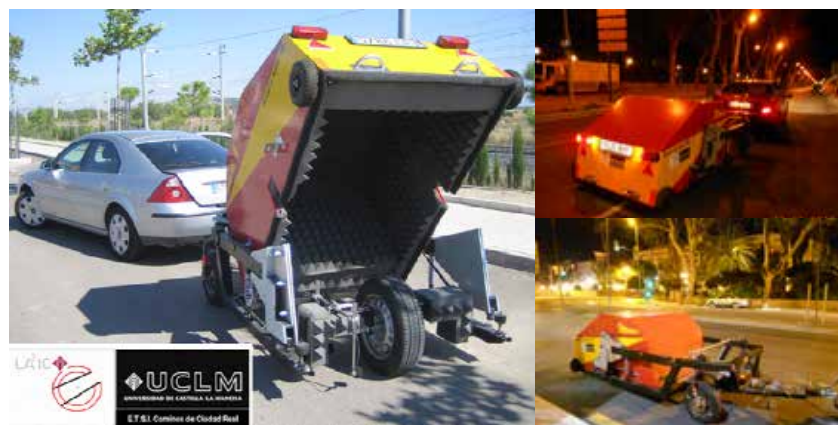
FIGURA 12: TIRESONICMk4-LA2IC (DERECHA: DURANTE LA AUSCULTACIÓN DEL TRAMO DE MÁLAGA)
