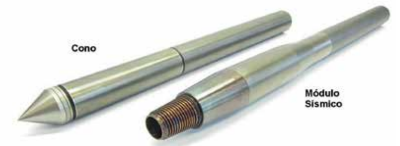
Figura 02. El SCPTu compuesto por el cono y su módulo sísmico.
