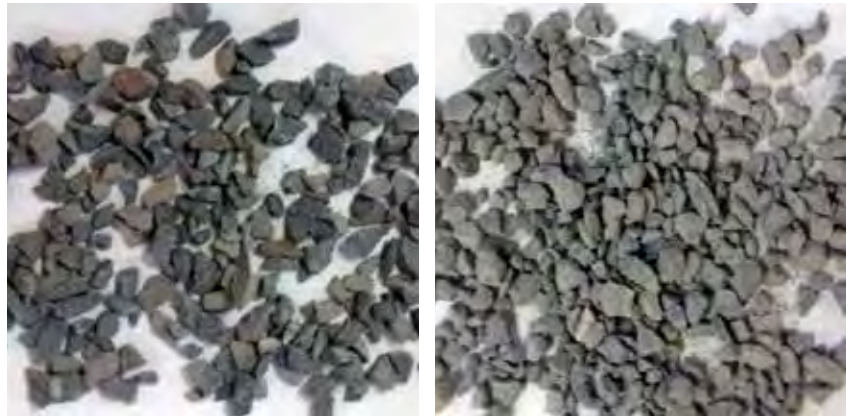
Figura 1: Reducción de lajas por remachaqueo del agregado.
