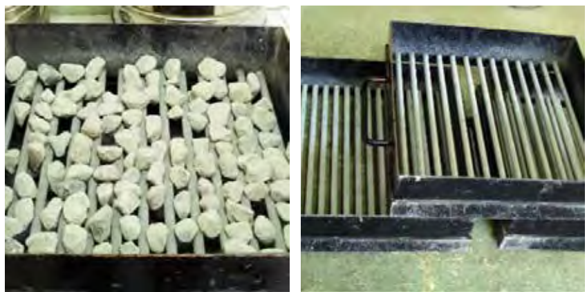
Figura 2: Tamices de barras para el Ensayo de índice de Lajas (EN 933-3).
