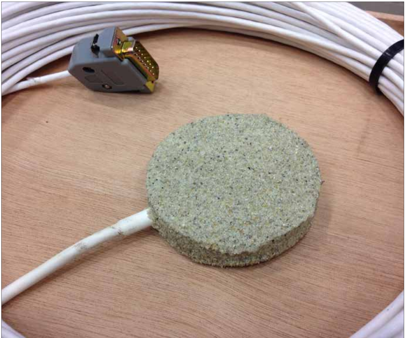
Figura 3. Celdas de presión utilizadas para medir la presión a nivel de subrasante.
