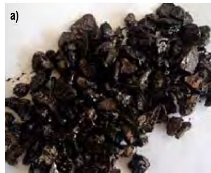
Figura 10: Envoltura de agregado con ligante asfáltico: mala (a) y buena (b) adhesividad. Fuente: TDM Perú
