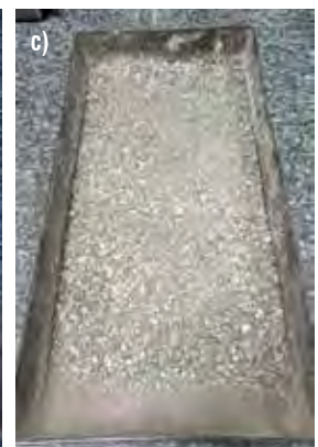
Figura 11: Agregados finos de diferente naturaleza. a) caliza (buena adhesividad) b) silícea c) pórfida
