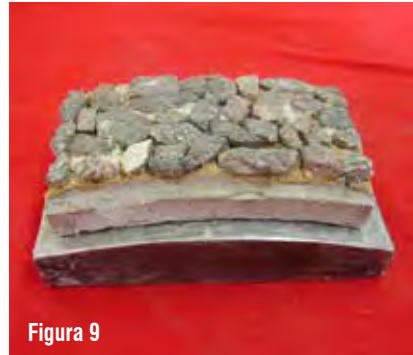
Figura 8: Máquinas empleadas para el ensayo de CPA (EN 1097-8). a) Péndulo de fricción; b) Máquina de pulimento. Figura 9: Pastilla para ensayo de CPA.
