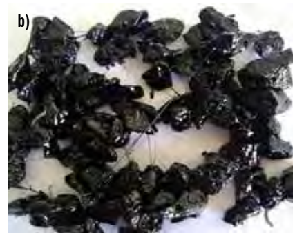
Figura 10: Envoltura de agregado con ligante asfáltico: mala (a) y buena (b) adhesividad. Fuente: TDM Perú
