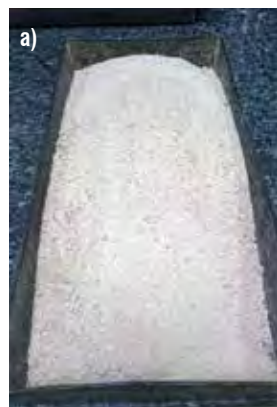
Figura 11: Agregados finos de diferente naturaleza. a) caliza (buena adhesividad) b) silícea c) pórfida
