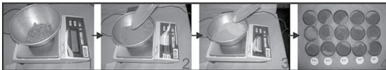
Figura 4: Dosificación controlada de agregados para cada cuerpo de prueba
