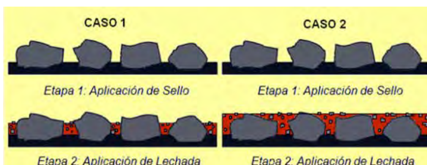
Figura 1: Estructura de un Capeseal (2)
