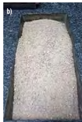
Figura 11: Agregados finos de diferente naturaleza. a) caliza (buena adhesividad) b) silícea c) pórfida
