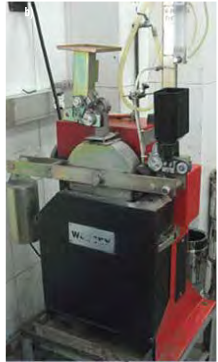
Figura 8: Máquinas empleadas para el ensayo de CPA (EN 1097-8). a) Péndulo de fricción; b) Máquina de pulimento. Figura 9: Pastilla para ensayo de CPA.
