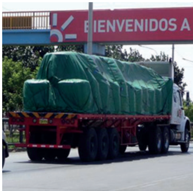
Vehículos T3S3, con neumáticos de banda ancha, transporte de carga pesada.
