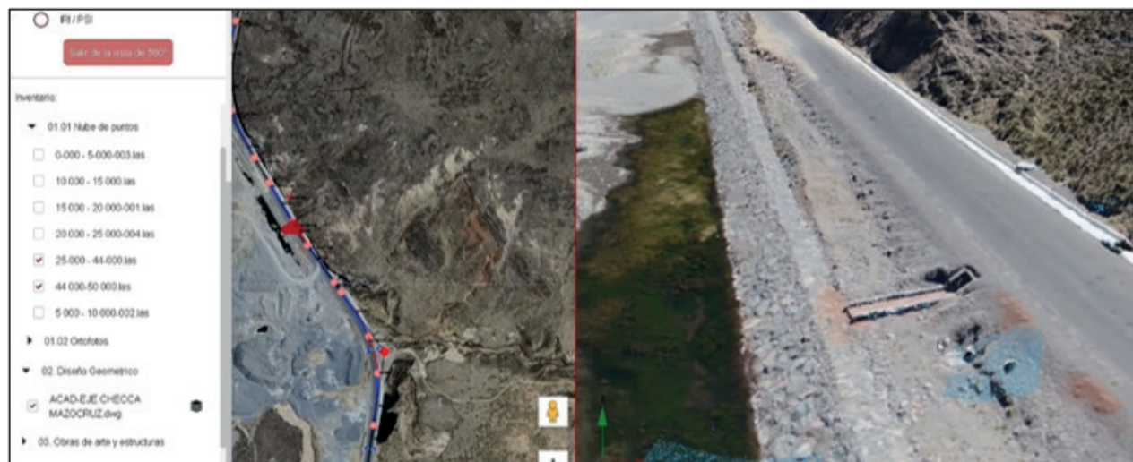
Figura 1. Integración de la representación del activo y su información técnica dentro del Modelo de Información del Activo: (a) representación digital de la infraestructura y (b) inventario georreferenciado con atributos asociados.
