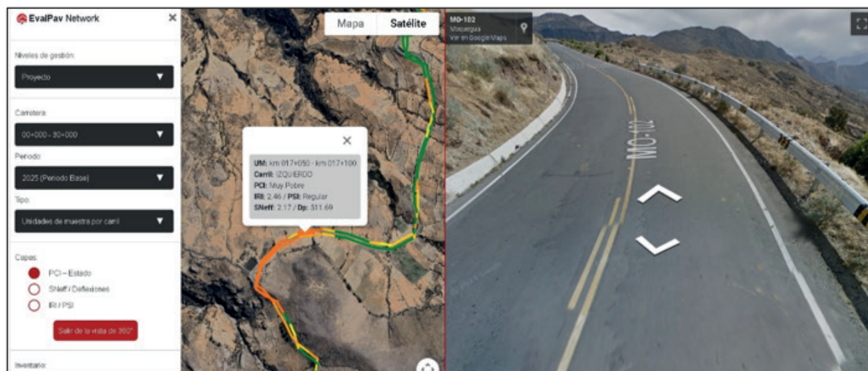
Figura 9. Representación georreferenciada de la condición del pavimento y de las necesidades de intervención para la gestión a nivel de red.
